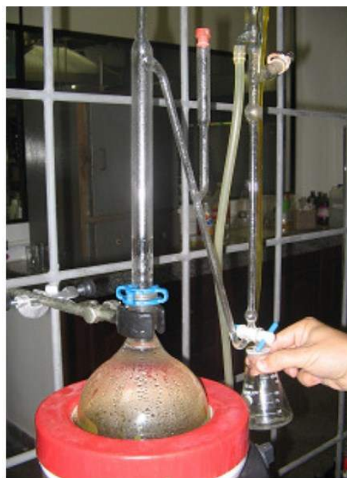
Figura 4: Extrator do tipo Clevenger utilizado na hidrodestilação das folhas da S. guianensis .
